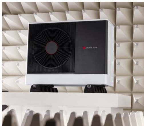
EMC-teszt az elektromágneses sugárzás kizárására
